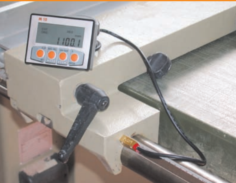
Applicazione su sezionatrice circolare tagli paralleli
